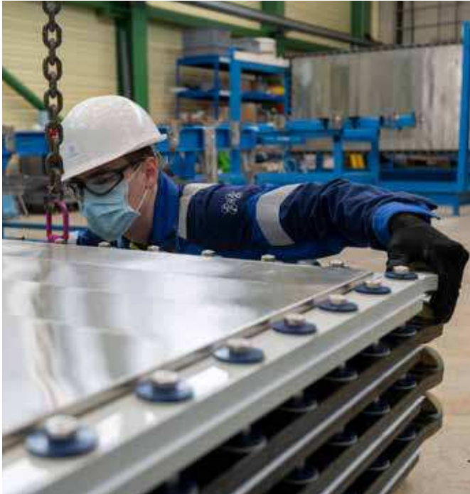
Grüne Wasserstoff-Lösung: Arbeiter von Nucera montiert Elektrolyse-Bauteil.
